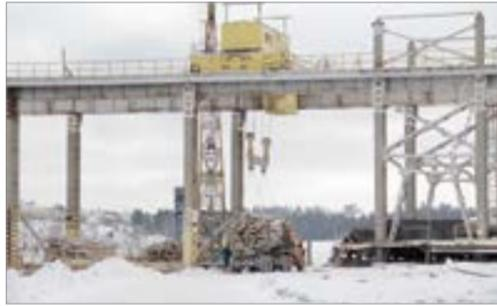
**Вторая очередь. Общий вид. Выгрузка леса с машин мостовым краном и подача на распиловку.** Зимой, когда прекращается речная навигация, доставку баланса с мест хранения на биржу осуществляют автотранспортом.
